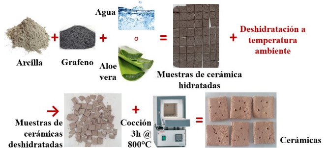
Fig. 2. Proceso de producción de los compuestos grafeno-cerámicos.
