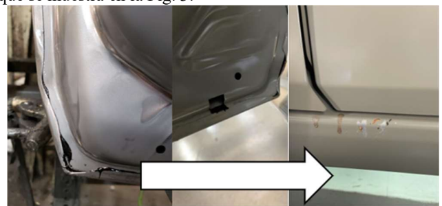
Fig. 3 - Adhesivo excedente en planta carrocería y adhesivo impregnado en panel de vista en planta pintura.
