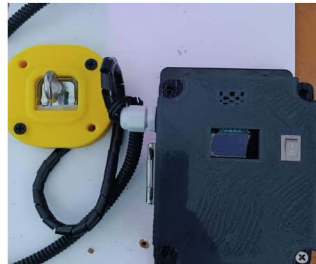
Fig. 5. Sistema de adquisición de datos terminado, accesorio de PETG para galga Sen-10245 (color amarillo), tapa diseñada e impresa con PLA (color negro).
