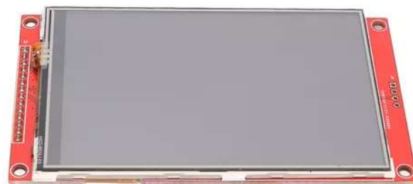
Fig. 1. Pantalla TFT de 4 pulgadas utilizada como interfaz principal.
