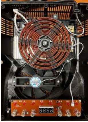
Fig. 3. Parrilla RC-12A3 con vistas a sus componentes internos .
