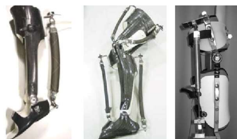
Fig. 4. Rehabilitador de tobillo usando músculos neumáticos.
